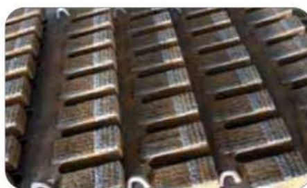
Cuchillas fundidas para niveladora con recubrimiento de tungsteno disponibles
